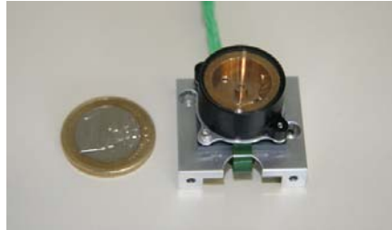
Reaktionsrad für Picosatelliten im Größenvergleich
