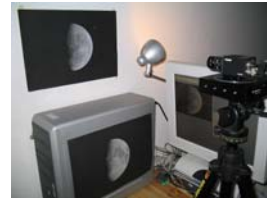
Testaufbau zum Moon-Tracking-Mode
