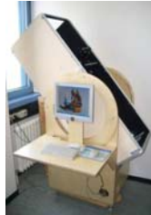
Kollimationsteststand zum Dobson Space Telescope
