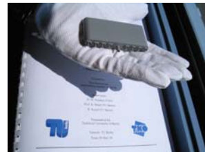
Entwicklungsmodell eines Picosatellitenantriebs auf Basis eines Cool Gas Generators (TNO und TU Berlin)
