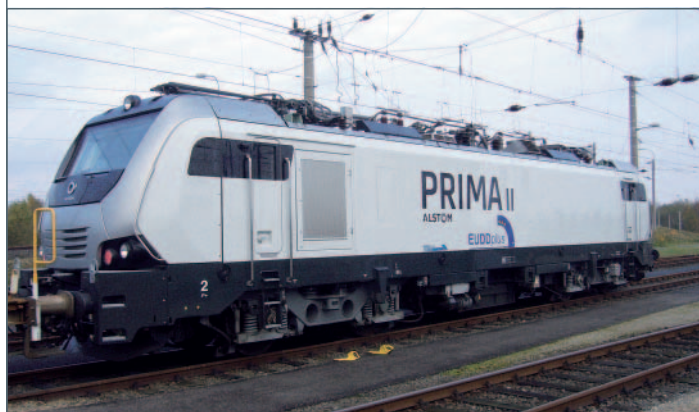
BILD 4: Mehrsystemlokomotive PRIMA II von Alstom als EUDD plus -Testplattform (Foto: Alstom)
