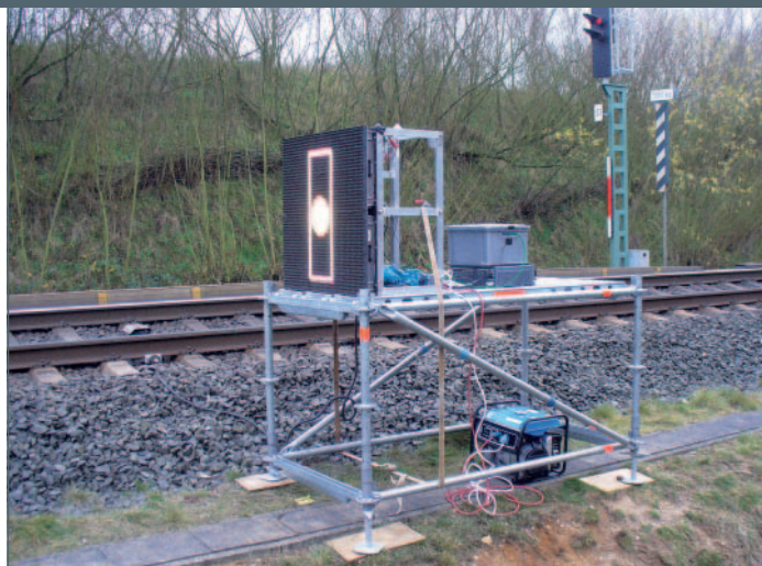
BILD 5: Flexible ortsfeste Signalisierung auf dem PCW-Testring T1 (Foto: EUDDplus)
